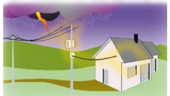
Descarga directa de un rayo sobre una línea aérea de tendido eléctrico
